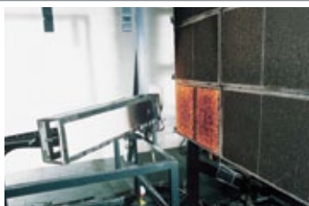
B3) La situación se mantiene prácticamente invariable, la zona dañada es mínima y la llama tiende a apagarse.
